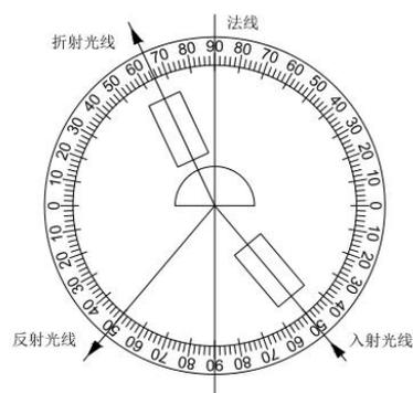
(3) 保持上述实验入射角度不变，我们将折射线的光路条形砖放置在反射角的一边，会发现光从空气射向半圆玻璃砖时，一部分光进入半圆玻璃发生折射，还有一部分光被界面反射在空气中传播。
