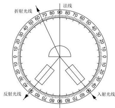
(4) 将光源放置在半圆的下方，让光从半圆玻璃砖中入射到空气中，重复上述实验可以知道，入射角  $\theta_1 <$  折射角  $\theta_2$ ，同时也符合入射角的正弦与折射角的正弦成正比的规律。
